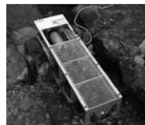
▲近くの用水路に設置された小水力発電。案内板のLED照明は電気を送る。
