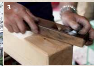
1_カタネボウ(担ぎ棒)にカンナをかける船本さん。2_制作途中の神輿。このあと紋や飾りが取り付けられる。3_担ぎ手がけがをしないう丁寧に角を丸くする。4_6月28日早朝、作業場前で神事が行われ、完成した神輿が白山神社に引き渡された。
