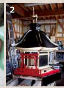
1_カタネボウ(担ぎ棒)にカンナをかける船本さん。2_制作途中の神輿。このあと紋や飾りが取り付けられる。3_担ぎ手がけがをしないう丁寧に角を丸くする。4_6月28日早朝、作業場前で神事が行われ、完成した神輿が白山神社に引き渡された。
