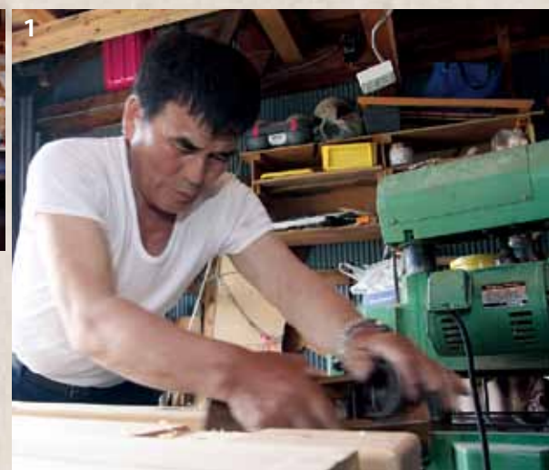
1_カタネボウ(担ぎ棒)にカンナをかける船本さん。2_制作途中の神輿。このあと紋や飾りが取り付けられる。3_担ぎ手がけがをしないう丁寧に角を丸くする。4_6月28日早朝、作業場前で神事が行われ、完成した神輿が白山神社に引き渡された。
