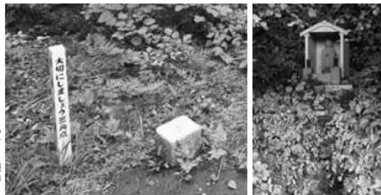
【写真左】鉢伏山頂上(543.6m)地点にある三角点には標識となる柱石が埋められている。緯度・経度・標高の基準点。
