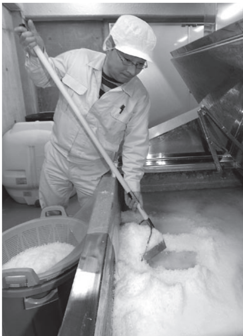
製塩装置から塩を取り出す豊原さん。煮詰めすぎると辛くなりすぎるので、濃度35%、約60 キ までの一番塩だけが製品化される。
