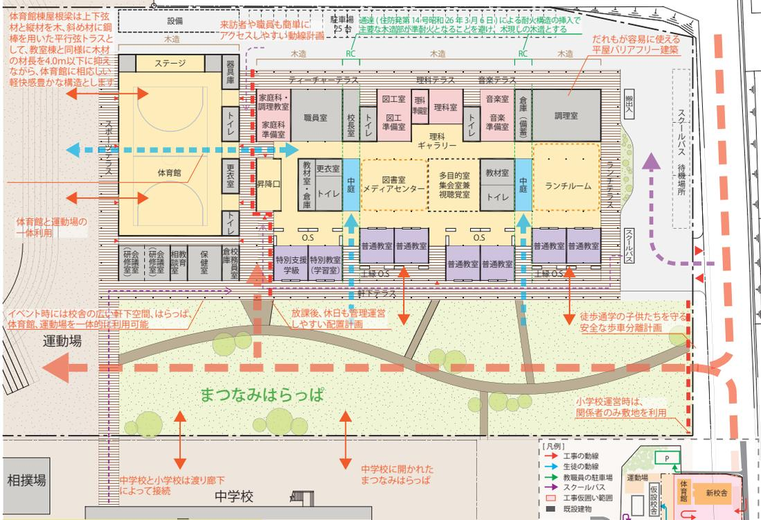
工事中における各動線と周辺環境への配慮: 校舎と体育館を北側に配置し、中学校校舎から距離を取ることで、工事中の埃や騒音の周辺への影響を極力抑え、安全かつ効率的に工事を進められる計画とします。安全に工事が行えるよう、生徒、教員、工事関係車両の動線を明確に分離します。
